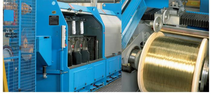
Mit modernster Maschinentechnik und unter Verwendung von Hochleistungskühlschmierstoffen werden die Drähte bis an 0,3 mm gezogen.
