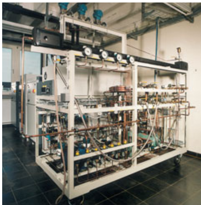
Versuchsanlage für Rohre und Wärmetauscher
