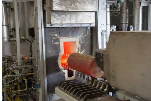
Bolzenentnahme aus dem Gasofen
