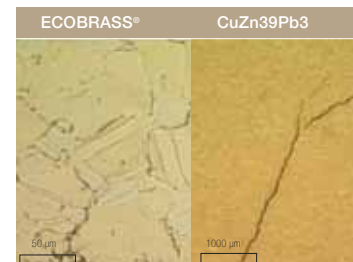
Essai selon DIN 50916-1, pt. 1 NH 3 | 12,5 % | 24 h
