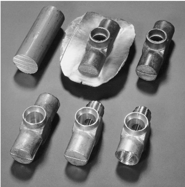
Von der Stange zum geschmiedeten Präzisionsteil
